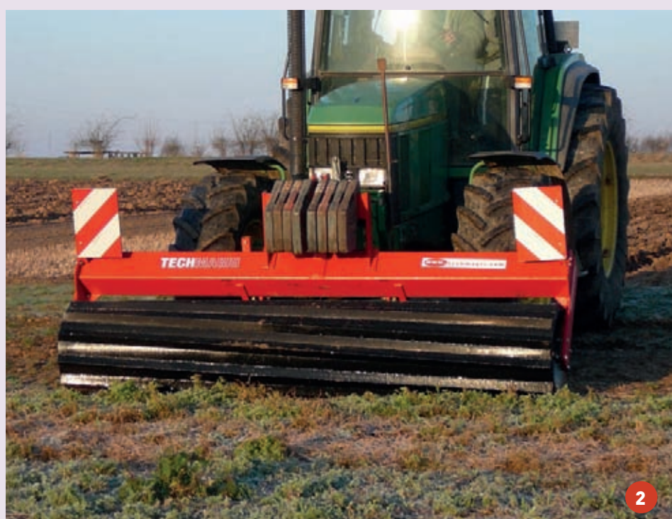
▲ Rolo faca "Master Fee" de Techmagri : utilisé en hiver sur les couverts il accentue l'effet de gel.
