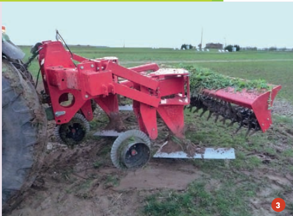
▲ "Glypho mulch" de Eco Mulch : il scalpe les plantes entre le collet et les racines.
